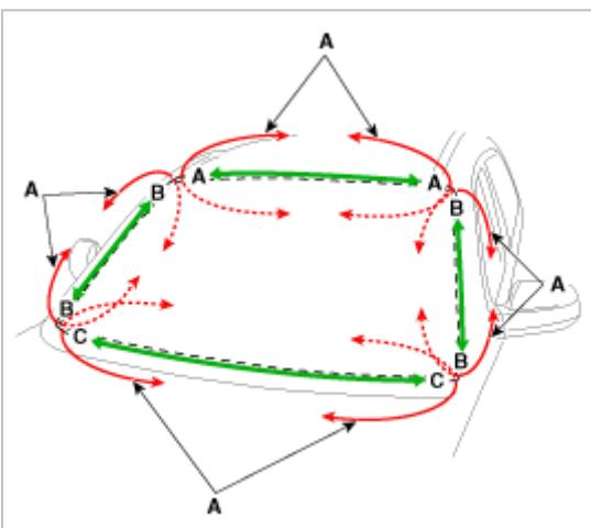
10. 使用玻璃吸盘(A)小心拆卸挡风玻璃(B)。
