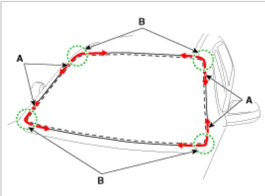
8. 将钢丝(A)穿入挡风玻璃的角部，并将钢丝的两端插入到拉线器内。
