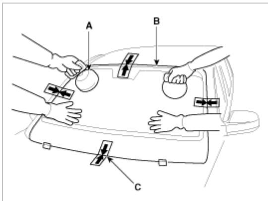
7. 为确定涂抹的密封胶完全硬化，在安装挡风玻璃后，将车辆停放在平坦地面上至少4个小时。
