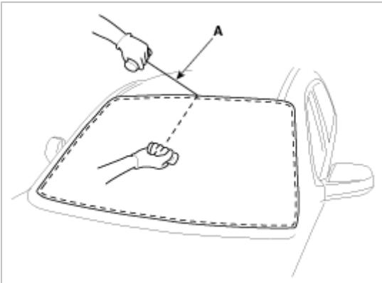
9. 左右拉动钢丝(A)，切断(A-A)、(B-B)、(C-C)部位的密封胶。
